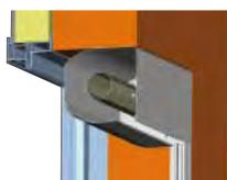
Sous le linteau, enroulement intérieur
