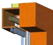
Caisson menuisé avec enroulement intérieur
