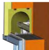
Caisson tunnel avec enroulement extérieur.
